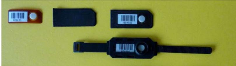
*Dosimetro per estremità con rivelatore di GR200 con supporto ad anello*
