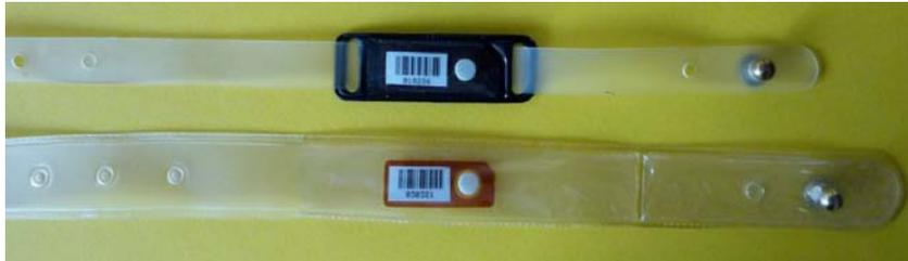
*Dosimetro per estremità con rivelatore di GR200 con supporto a bracciale e bracciale sterilizzabile*
